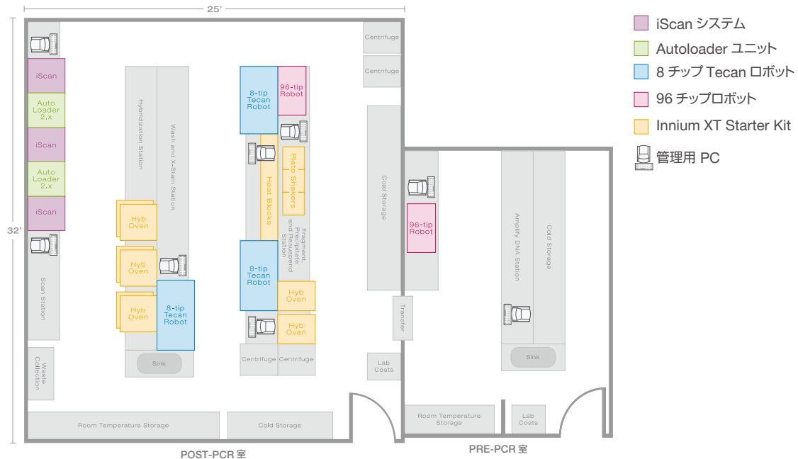
図 3: Infinium XT を用いた生産規模のジェノタイピングのためのラボレイアウト例 このレイアウト例では、年間サンプル数が 100 万を超えるラボを想定しています。(8 チップ) Tecan ロボット 3 台、iScan システム 3 台、AutoLoader 2.x ユニット 2 台、ベンチトップ型 96 チップリキッドハンドリングロボット 2 台、および補助装置で構成されています。このレイアウト例には、約 800 平方フィート (約 74 平方メートル) のスペースが必要です。レイアウトは正確な縮尺ではありません。
