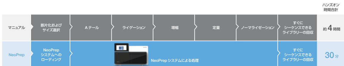
図 1 : マニュアルおよび NeoPrep による TruSeq Nano DNA ライブラリー調製のワークフロー。どちらのワークフローも断片化した gDNA からスタートします。NeoPrep システムでは、ハンズオン時間が 4 時間から 30 分に短縮されます。
