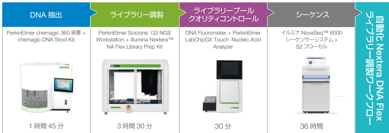
図 2：メタゲノム解析用の自動化 Nextera DNA Flex ライブラリー調製ワークフロー イルミナと PerkinElmer が共同で、ハイスループットメタゲノム解析のために、包括的に自動化した NGS ライブラリー調製ワークフローを作成しました。
