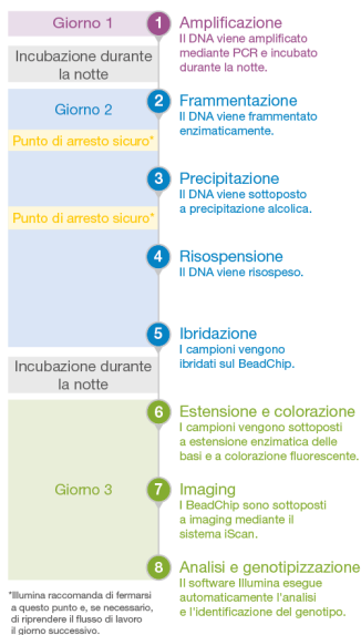
Figura 2: Miglioramenti del flusso di lavoro Infinium XT: ogni fase del flusso di lavoro Infinium è ottimizzata nel flusso di lavoro Infinium XT, riducendo il tempo di elaborazione da tre a due giorni.
