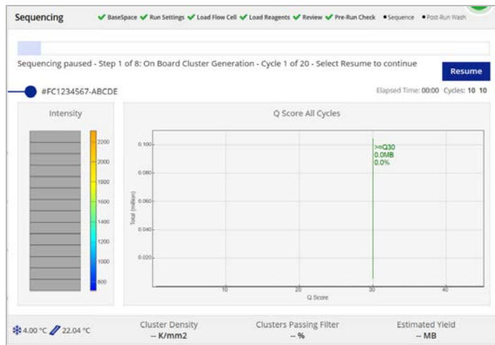
Abbildung 21 Sequenzierungsbildschirm eines unterbrochenen Laufs
