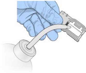
Abbildung 10 Spülen der Fließzelle
