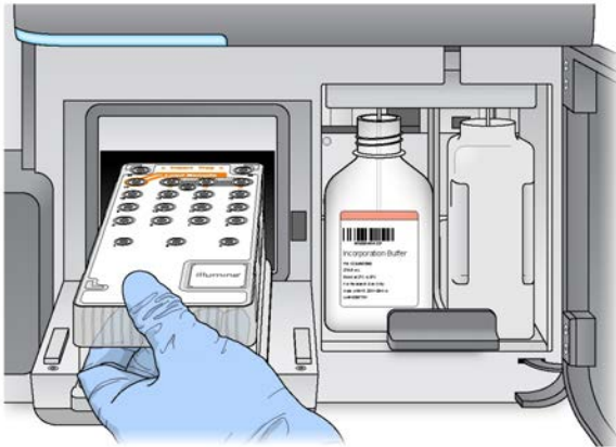
Abbildung 18 Laden der Reagenzienkartusche
