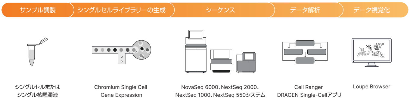
図1: シングルセル遺伝子発現実験のワークフロー: シングルセルまたはシングル核の懸濁液から開始し、次にChromium装置によるマイクロ流体のシングルセル分画化とバーコード付加が続きます。得られたシングルセル遺伝子発現ライブラリーをイルミナシステムでシーケンスします。Cell RangerおよびLoupe Browserソフトウェア、またはDRAGEN Single-Cellパイプラインを使用してデータを解析し視覚化します。
