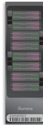
Abbildung 1: Infinium CytoSNP-850K v1.3 BeadChip: Der Infinium CytoSNP-850K v1.3 BeadChip für 8 Proben stellt zytogenomisch relevante Gene für konstitutionelle und Krebsstudien mit Inhalten der ICCG und des CCMC bereit.
