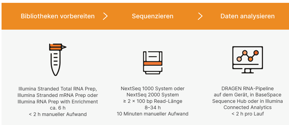
Abbildung 1: RNA-Seq-Workflow auf dem NextSeq 1000 und dem NextSeq 2000: Das NextSeq 1000 System und das NextSeq 2000 System sind Teil eines einfachen, integrierten NGS-Workflows, der hochpräzise RNA-Sequenzierungsdaten liefert. Die Zeiten variieren je nach Versuch und Assay-Typ.
