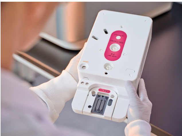
Figura 4: Cartucho de reactivos NextSeq 1000 y NextSeq 2000. El cartucho integrado incluye reactivos, flúidica y el soporte de residuos. Solo tiene que descongelar y preparar el cartucho de reactivos, insertar la celda de flujo, cargar la librería y colocarla en el instrumento.
