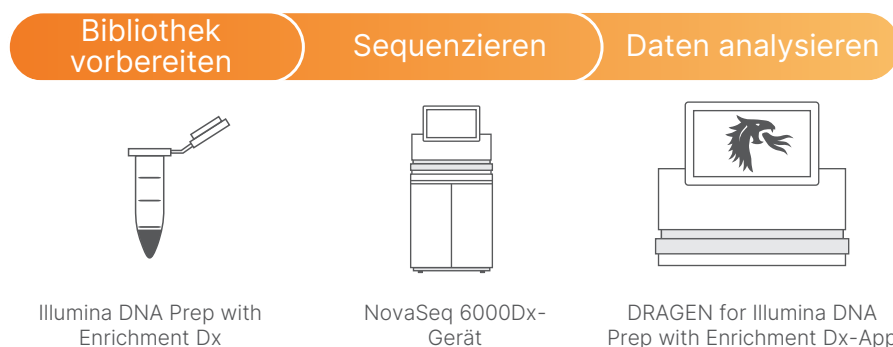
Abbildung 1: Workflow für das Varianten-Calling: Das NovaSeq 6000Dx-Gerät ist Bestandteil eines integrierten Workflows mit drei Schritten, der die Bibliotheksvorbereitung, die Hochdurchsatzsequenzierung im IVD- oder RUO-Modus und die beschleunigte Sekundäranalyse der Daten mit einem gekoppelten DRAGEN Server umfasst.
