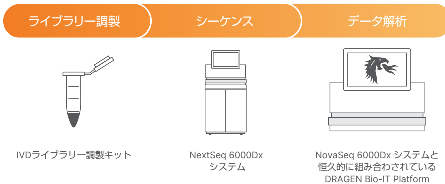
図 2: NovaSeq 6000Dx システムワークフロー: NovaSeq 6000Dx システムは、ライブラリー調製、診断(IVD)またはRUOモードのハイスループットシーケンスおよびDRAGEN サーバーと対になった高速二次データ解析が含まれる統合型の3ステップワークフローの一部です。
