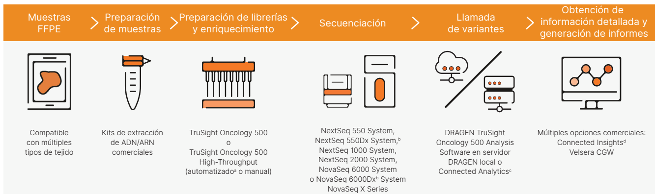
Figura 2: Flujo de trabajo de TruSight Oncology 500. TruSight Oncology 500 y TruSight Oncology 500 High-Throughput se integran en los flujos de trabajo de laboratorio actuales, desde los ácidos nucleicos hasta las llamadas de variantes en cuatro días.
