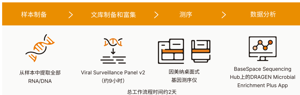
图1: Viral Surveillance Panel v2工作流程——全面的一体化工作流程，利用环境或宿主样本制备文库，在因美纳基因测序仪上测序，并使用DRAGEN Microbial Enrichment Plus App进行分析，从而实现病毒检测、全基因组共有序列生成、最佳匹配病毒的序列定位和毒株分型。测序时间因样本测序深度和所使用的基因测序仪而异。
